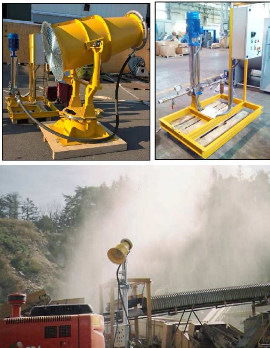
Figura 24 - Sistema ACOVENT DS710 per nebulizzazione con funzione di abbattimento polveri
