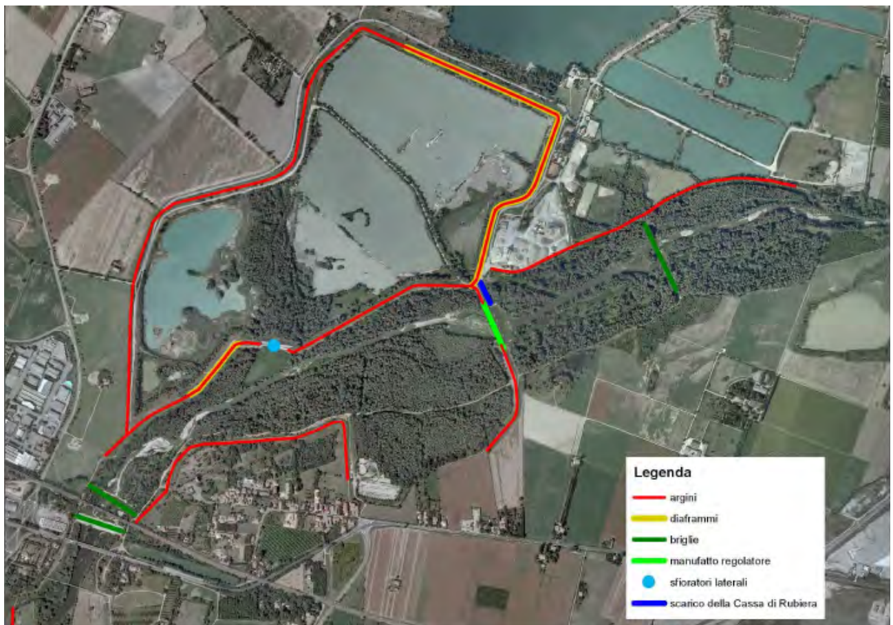
Opere idrauliche che costituiscono la cassa di espansione esistente
