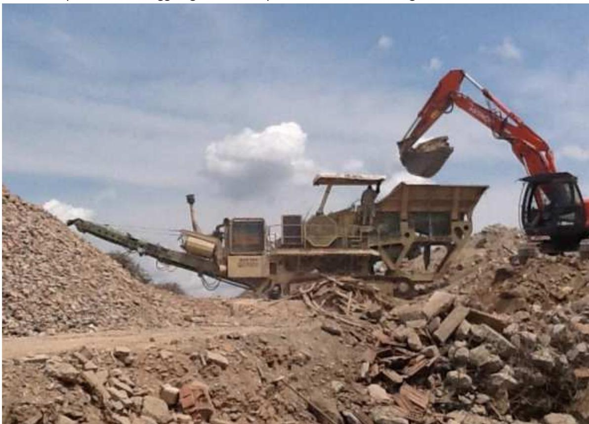
Figura 14 -Frantumatore REV "gruppo cingolato semovente" - mod GCR 106 (foto Internet)
