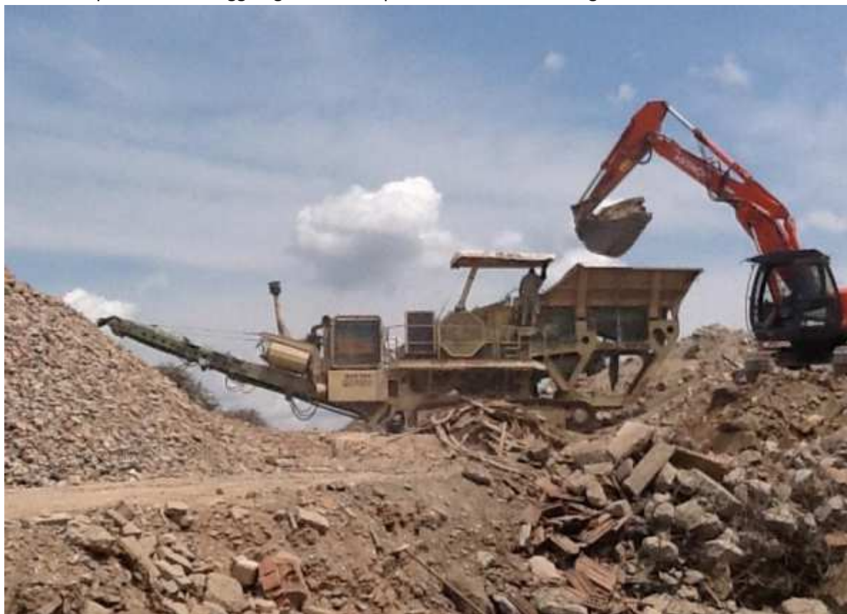
Figura 14 -Frantumatore REV "gruppo cingolato semovente" - mod GCR 106 (foto Internet)
