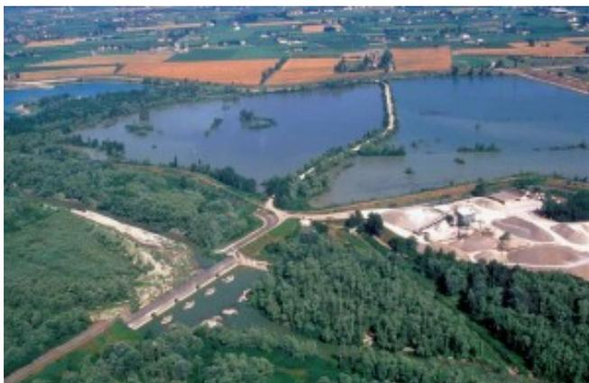
Il volume di acqua che si può accumulare nelle casse, è di circa 15.000.000 m<sup>3</sup> e viene riceduto all'alveo idraulicamente grazie allo scaricatore di fondo. Con questo sistema, completato a monte e a valle da altri manufatti finalizzati a regolare afflussi e deflussi, possono essere controllate portate di piena altissime. L'intero sistema ha dato risposte positive ma esiste l'esigenza di aumentare la capacità di invaso.
