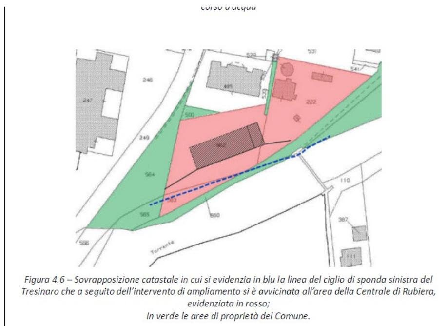
Figura 4.6 – Sovrapposizione catastale in cui si evidenzia in blu la linea del ciglio di sponda sinistra del Tresinaro che a seguito dell'intervento di ampliamento si è avvicinata all'area della Centrale di Rubiera, evidenziata in rosso; in verde le aree di proprietà del Comune.
